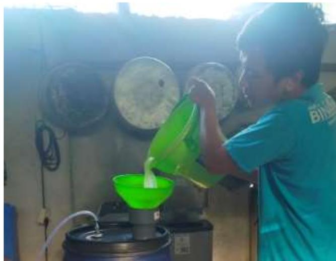
Gambar 6. Proses memasukkan limbah cair tempe kedalam reaktor biogas
