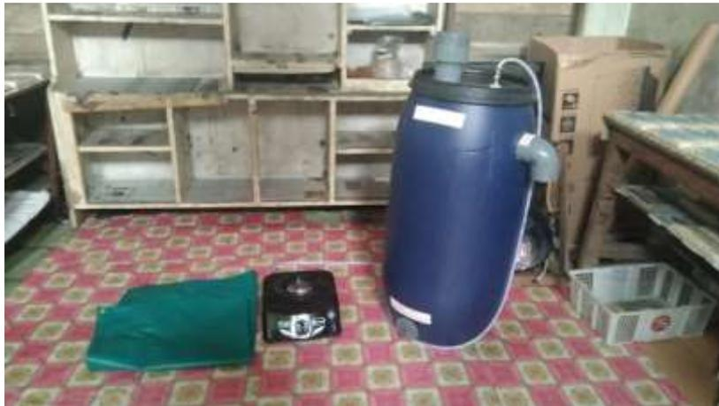
Gambar 4. Rangkaian Biogas Digester
