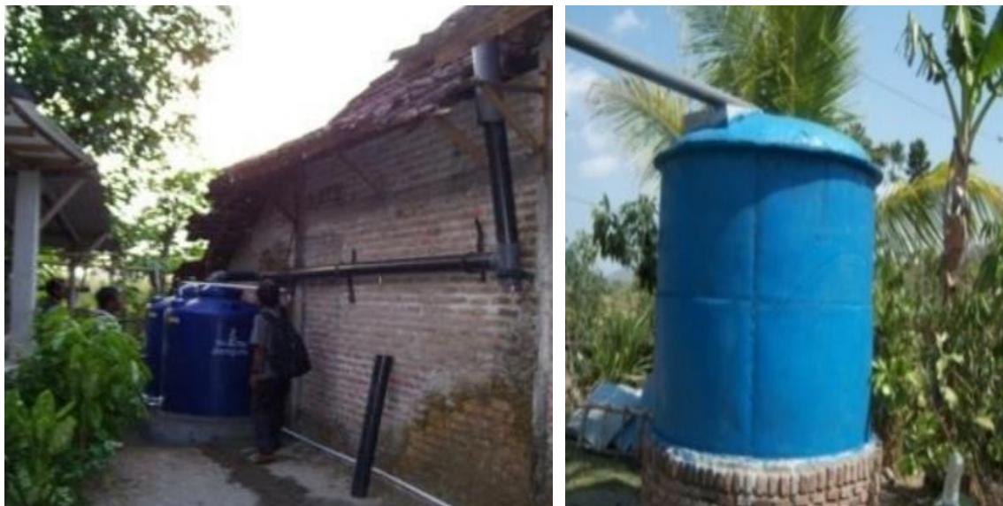
Gambar 3. PAH metode penampungan dengan Tandon (Sumber : Nani Heryani dkk 2013 [27])
