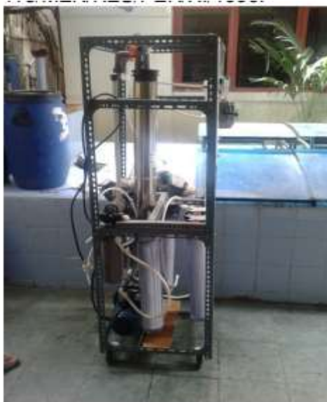
Gambar 4. Alat pengolah air gambut dan Aliran pengolah air gambut
