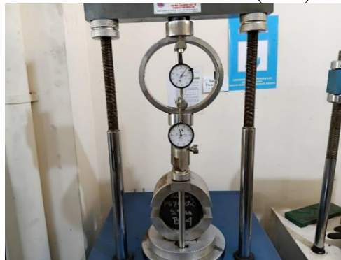
Gambar 2. Pengujian Marshall Sumber: Analisis Peneliti (2026)
