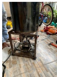
Gambar 3. Hasil redesain mesin peniris minyak
