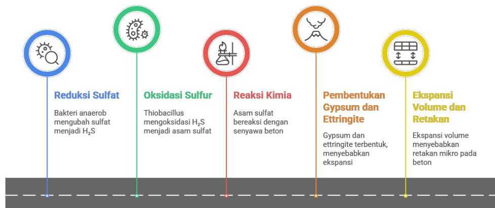
Gambar 1. Proses Bio-korosi pada Beton
