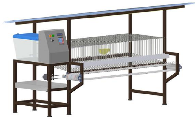
Gambar 3. 1 Desain 3D Kandang Burung Puyuh Otomatis (Sumber : Dokumentasi Pribadi)
