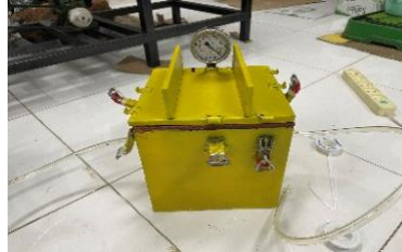
Gambar 4. Hasil pembuatan catch pot
