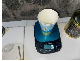
Gambar 8. Penimbangan resin dan hardener
