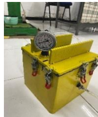
Gambar 5. Pemeriksaan kebocoran terhadap catch pot
