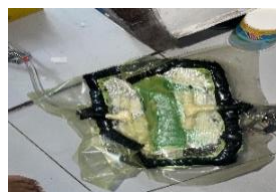
Gambar 7. pemeriksaan kebocoran pada molding
