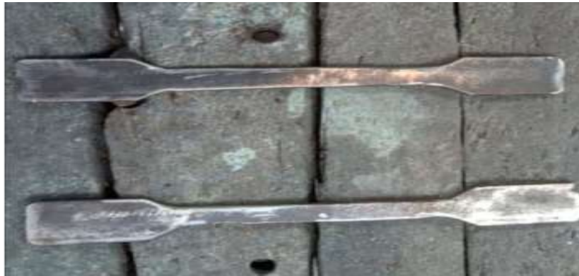
Gambar 17 Spesimen uji 110A dengan kampuh las 2mm & 3mm
