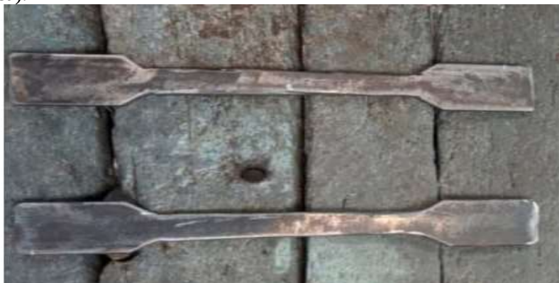
Gambar 15 Spesimen uji 90A dengan kampuh las 2mm & 3mm
