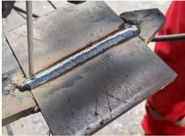
Gambar 4 Hasil pengelasan 100A dengan kampuh las 2mm
