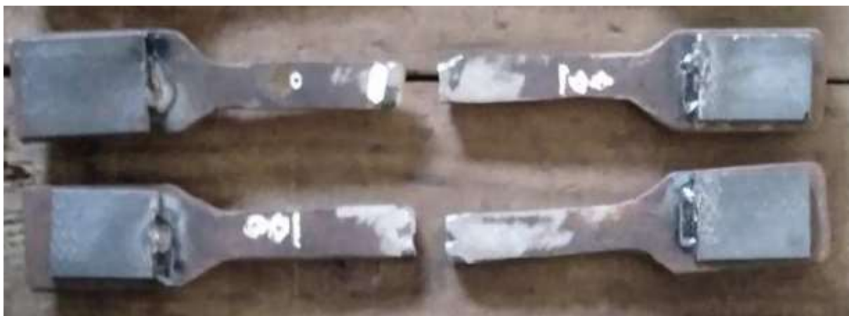
Gambar 19 Hasil uji Tarik 100A dengan kampuh las 2mm & 3mm
