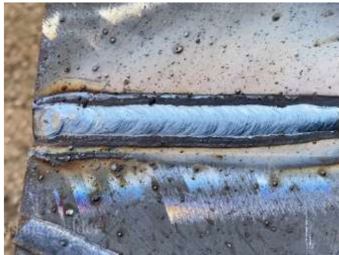
Gambar 2 Hasil pengelasan 90A dengan kampus las 2mm
