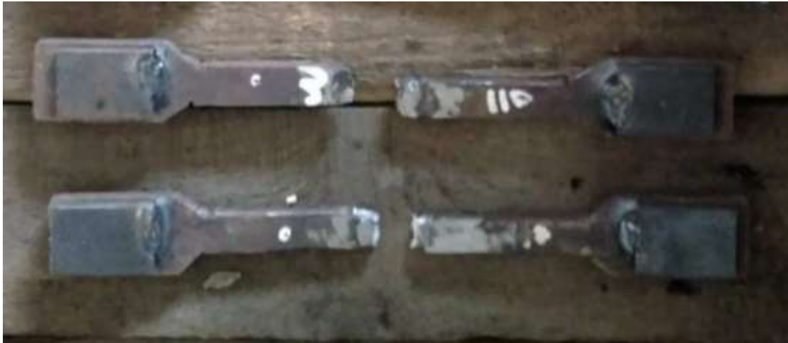
Gambar 20 Hasil uji Tarik 110A dengan kampuh las 2mm &amp; 3mm
