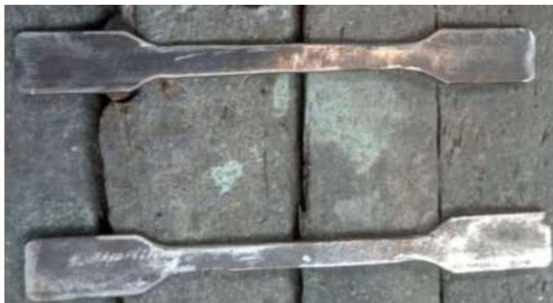
Gambar 16 Spesimen uji 100A dengan kampuh las 2mm & 3mm
