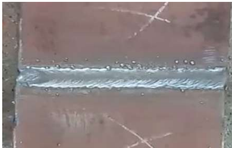
Gambar 6 Hasil pengelasan 110A dengan kampuh las 2mm
