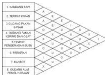
Gambar 2. Diagram ARC pada Barokah Farm
