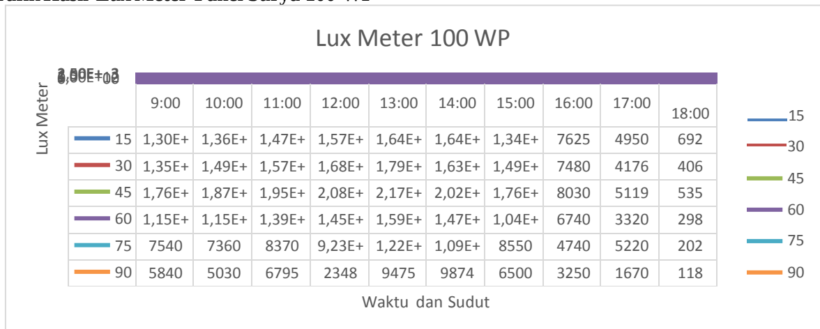
Gambar 2 Grafik Hasil Pengujian Lux Meter pada Panel Surya 100 WP dengan Sudut Kemiringan 15°, 30°, 45°, 60°, 75° dan 90°
